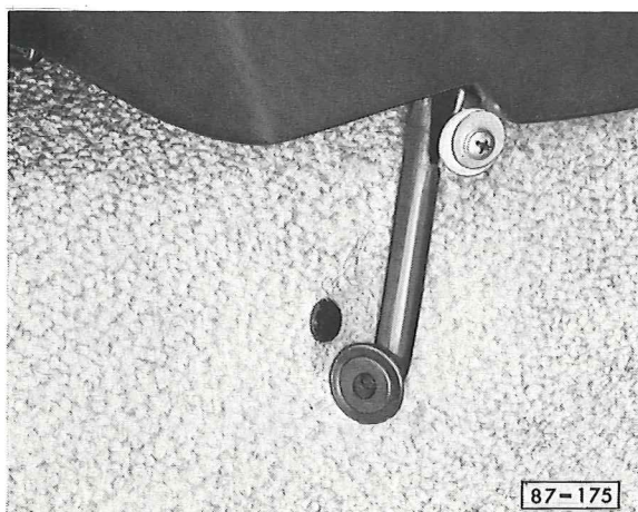
Fig. 6 Reprise du flexible d'écoulement d'eau Agrafer le flexible d'écoulement d'eau dans le tunnel du châssis.
