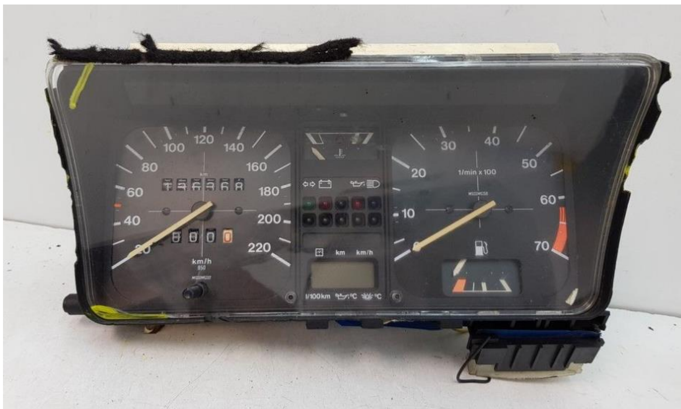
Compteur MOTOMETER avec MFA - Température Eau en haut et jauge carburant à droite
