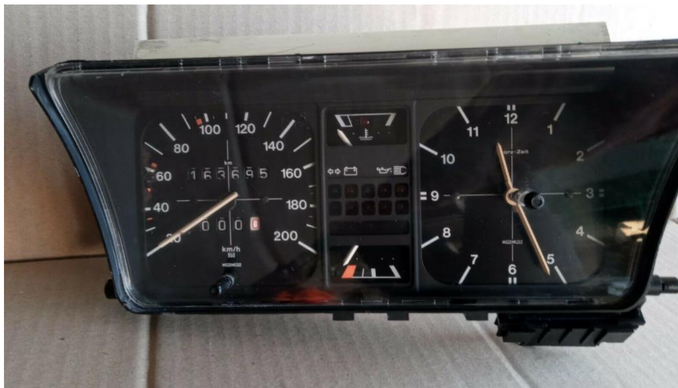
Compteur MOTOMETER sans MFA - Température Eau en haut et jauge carburant en bas
