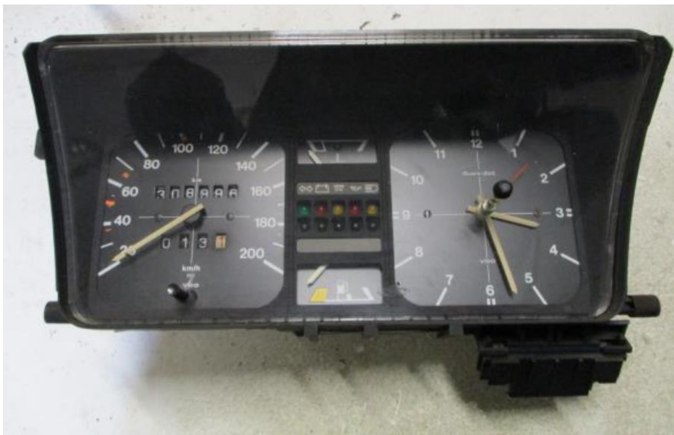
Compteur VDO sans MFA (Golf 1 Diesel) - Température Eau en haut et jauge carburant en bas
