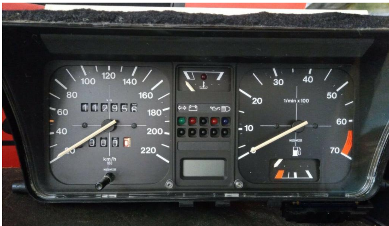
Compteur MOTOMETER – Température en haut et jauge carburant à droite
