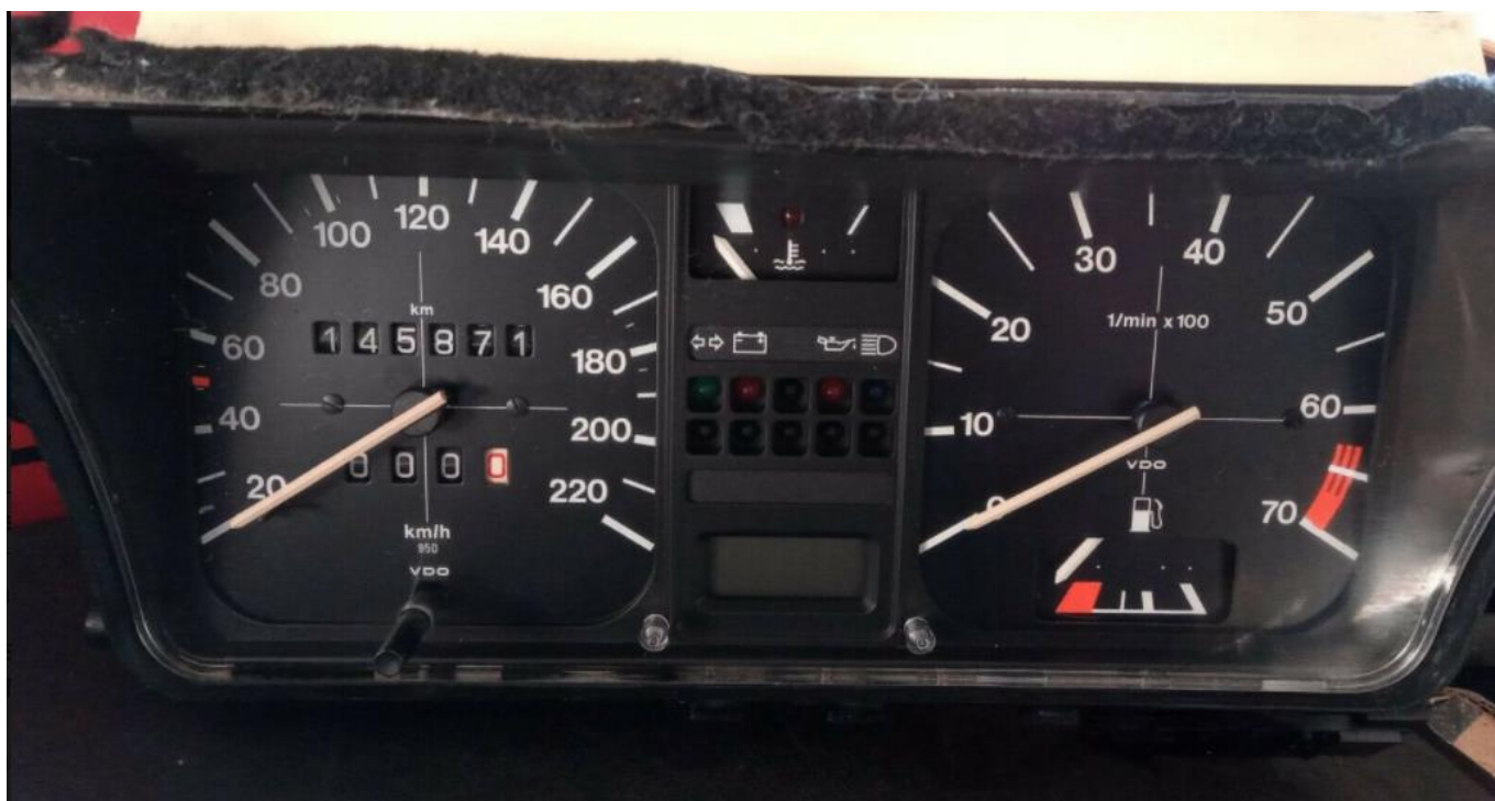
Compteur VDO sans MFA - Température Eau en haut et jauge carburant à droite
