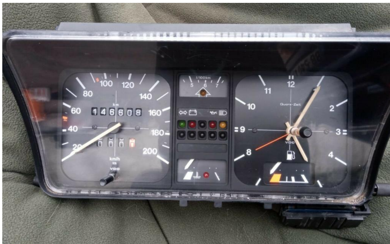
Compteur VDO sans MFA – Economètre en haut, Température Eau en bas et jauge carburant à droite
