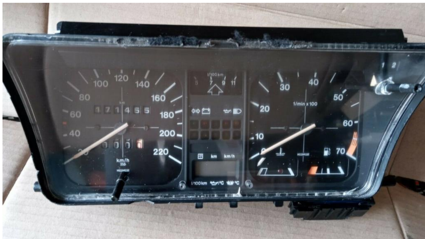
Compteur MOTOMETER - Economètre en haut, Température Eau et jauge carburant à droite
