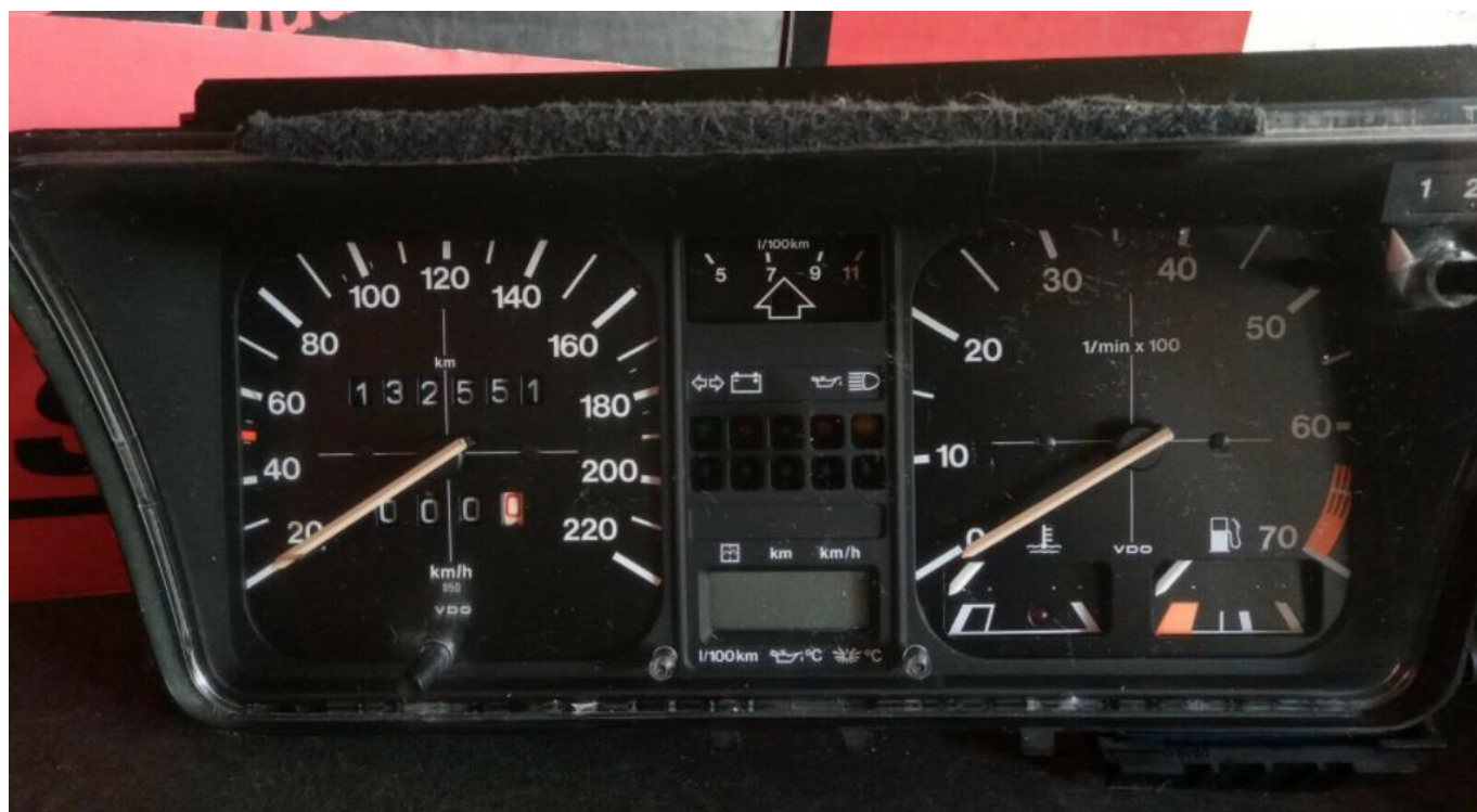
Compteur VDO avec MFA - Economètre en haut, Température Eau et jauge carburant à droite
